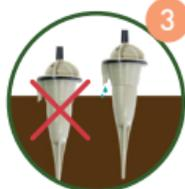
3 Quand vous plantez le goutteur, le trou de sortie de la goutte ne doit pas se trouver au contact de la terre. Plantez le goutteur bien droit 3
