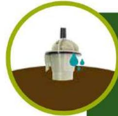
Si votre terrain est en pente, pour un bon fonctionnement, la hauteur entre le niveau d'eau dans la réserve et le dernier goutteur de la ligne ne doit pas dépasser 1,50 m. Sinon l'eau sortira par le trou d'air du chapeau (voir schéma montage du kit) et videra votre réserve en peu de temps.
